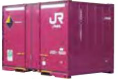
従来のJRコンテナより100mm高い2,600mmとなり、かさ高貨物に対応できます。20Dは両側面が開き、20Gは側面と妻面が開きます。
