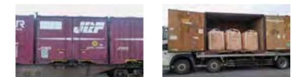
廃棄物専用12ftコンテナ 積載例(フレコンバック)
