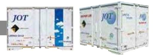
コンテナの内壁に高性能断熱材を使用しており、高い保冷(保温)性能を備えています。なお、真空断熱パネルを採用した「SUPER UR」(日本石油輸送の登録商標・写真右)は、さらに高い断熱性能を実現しています。
