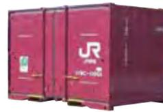
コンテナ室内から開閉可能な通風装置が設置されており、室内の換気ができます。両側面が開くV19Cと、側面と妻面が開くV19Bの2種類があります。
